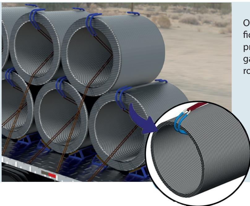
Os ganchos são usados para a amarração dos rolos fio máquina. Cada rolo recebe 2 ganchos que são presos à cordas ou cintas, que de forma cruzada, garantem a estabilidade e o posicionamento dos rolos.
